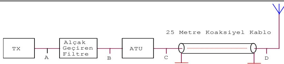
4) Yukarıdaki istasyon sisteminde, telsiz birimine geri dönen RF gücü ölçülmek istenirse, SWR metre hangi nokta arasına bağlanmalıdır?
